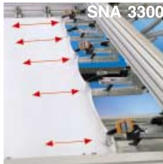
Automatisches Greifen, Spannen und Ausrichten des Nähgutes am Warenauslauf
