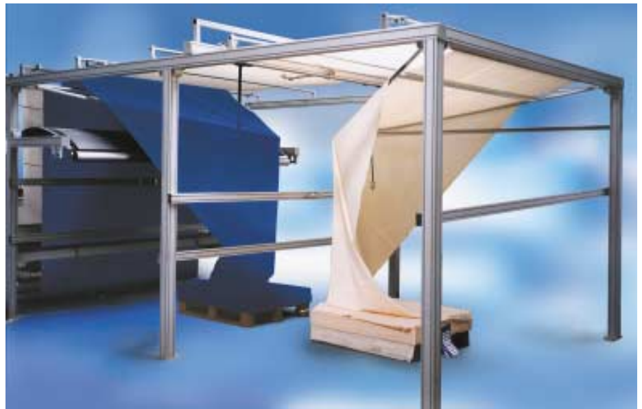
Doppelpalettenzuführung mit Entdoppiervorrichtung
