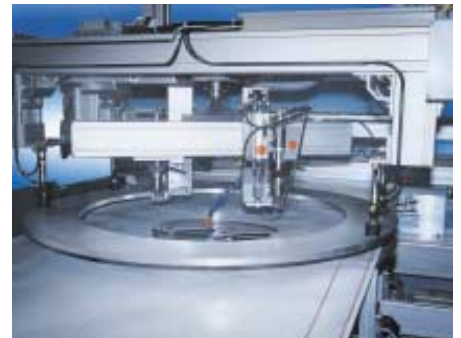
Ausschneiden mit Ultraschall
