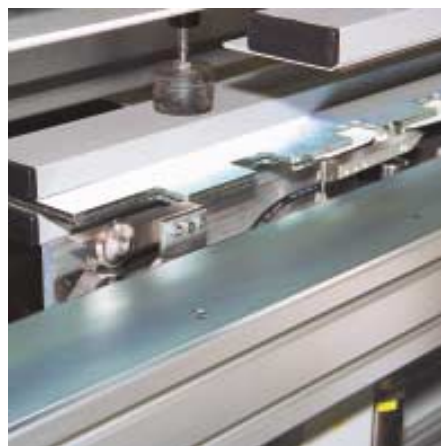
Querschneiden mit Ultraschall
