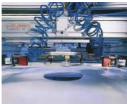
Querschneiden mit Ultraschall
