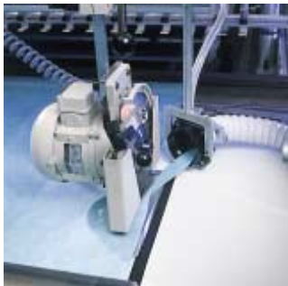
Längsschneiden und Absaugen
